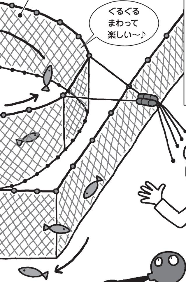
定置網漁は、海に固定された網の中に魚の群れが入ってくるのを待つ漁法で、身網を水深27m以上に設置する大型定置網と、それより浅い場所に設置する小型定置網があります。
